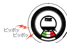
緑(電源)ランプ点灯 赤(ガス警報)ランプ点灯
