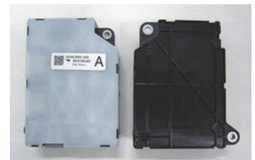
リチウムイオン電池セル電圧監視ユニット
