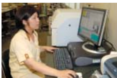
XRF分析器による鉛含有量の測定
