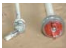
エアカーテン方式の塗装ノズル (左:旧型 右:新型)
