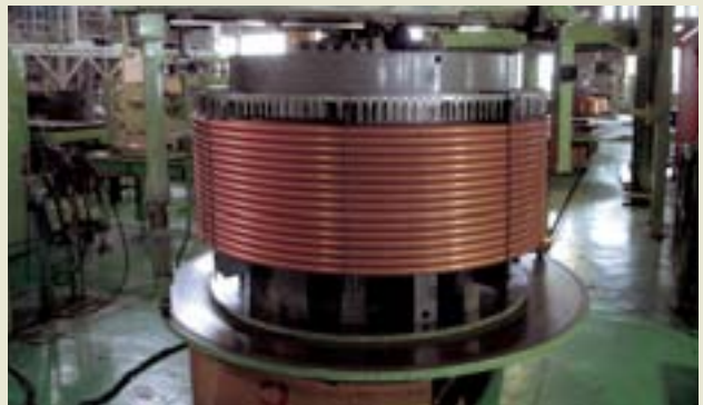
業務用空調機にはクルマの生産と同じような大規模設備が必要。 写真は銅管加工後の空調機内部
